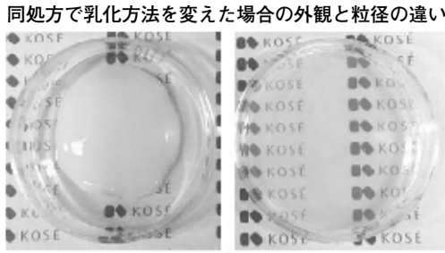
同処方で乳化方法を変えた場合の外観と粒径の違い 一般的乳化法 外観：クリーム様 粒径：約1μm αゲルカプセル法 外観：化粧水様 粒径：約0.1μm
