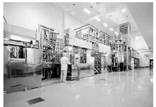
香取第二工場では、床は菌の繁殖を防ぐオールドライ仕様、水は365日・80℃でまわす。上は真空乳化装置、下は調剤室
